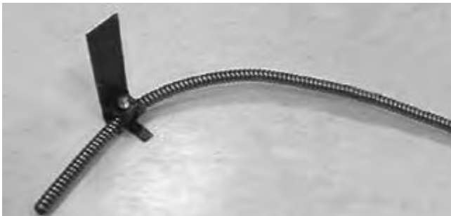
Abbildung 18 – Drehmomentverstärker an Spirale befestigt. Die Spirale sollte permanent gebogen sein, wie gezeigt, wenn die Klammer etwa 2" hinter dem Ende der Spirale angebracht ist
