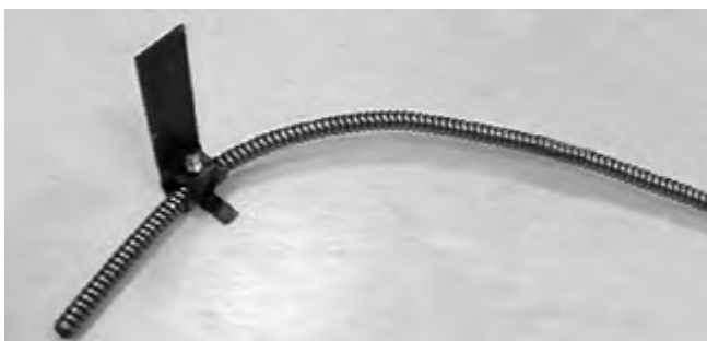
Figure 18 – Bras de levier attaché au câble. Le câble doit être coudé comme indiqué, avec la pince montée à environ 2 pouces de son extrémité
