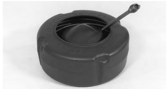
Abbildung 19 – Beim Einlegen der Spirale in eine Innentrommel die Spirale im Uhrzeigersinn aufwickeln.
