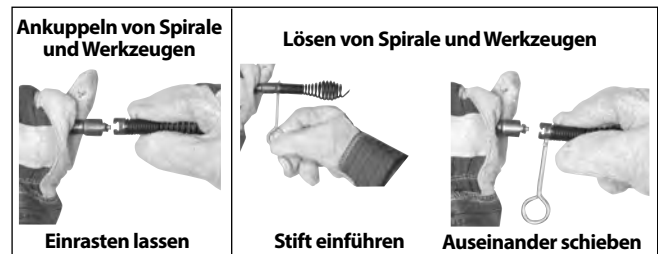
Abbildung 8 – Anschließen und Lösen von Werkzeugen
