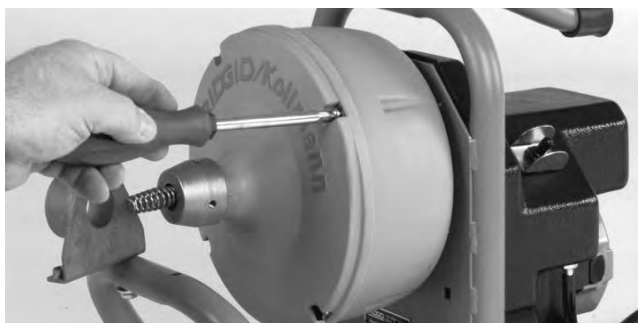
Abbildung 16 – 4 Trommelschrauben etwa 3 Umdrehungen lösen, aber nicht entfernen
