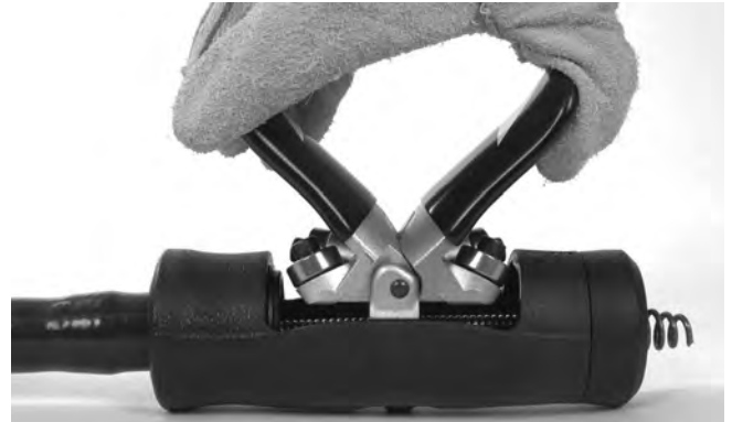
Abbildung 4 – Vorwärtsschieben der Spirale mit AUTOFEED
