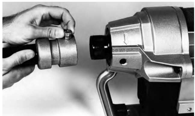
Figura 4 – Acoplamiento de la manguera guía trasera
