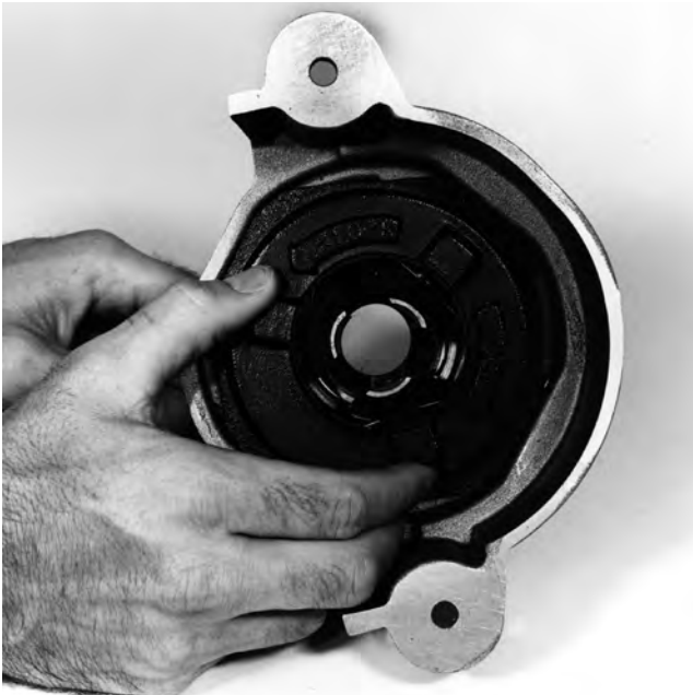
Figure 12 – Retrait du couvercle des mâchoires
