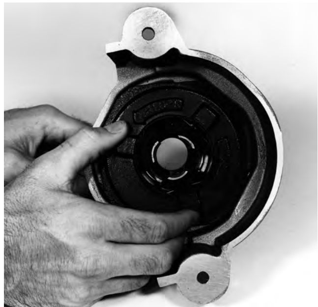
Figura 12 – Desmonte la tapa del juego de mordazas
