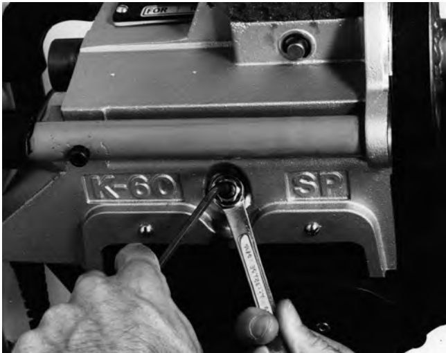
Figure 14 – Serrez l'écrou de blocage
