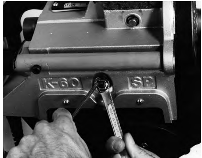
Figura 14 – Apriete la tuerca de inmovilización
