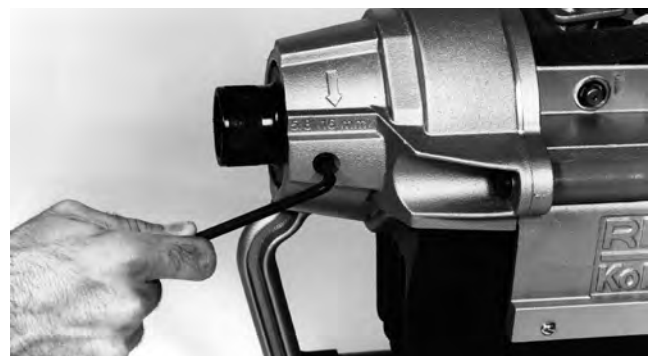
Figure 9 – Desserer la vis de blocage
