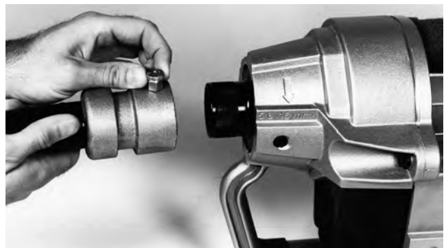
Figure 4 – Montage du guide-câble arrière
