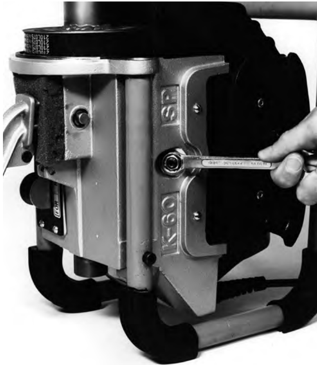
Figura 13 – Afloje la tuerca de inmovilización
