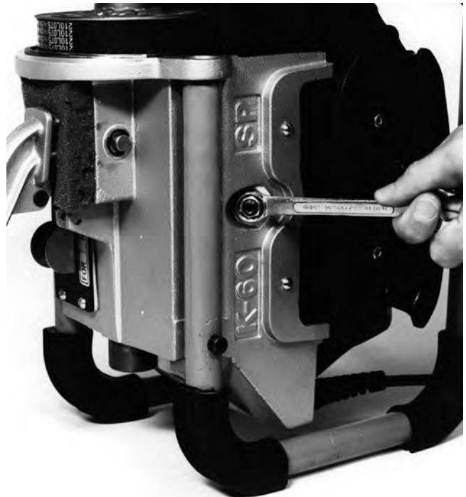
Figure 13 – Desserrez l'écrou de blocage
