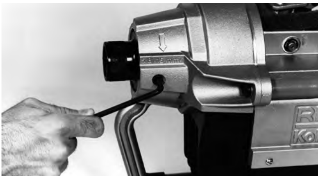
Figura 9 – Afloje el tornillo de retención
